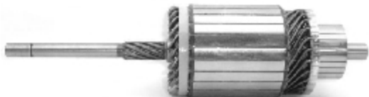
IM 510 12 V Replacing: 101649, 132199, NE054 Slots: 25 O.D. 75,9 L. 291,0
