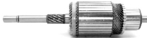
IM 954 12 V Replacing: 134122, 4185546, 74845901, 74895901 Servicing: 4172113, 63224600, 63224602 Slots: 37 O.D. 82,6 L. 336,5
