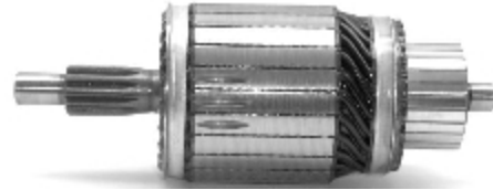
IM 3144 12 V 1.7 Kw Replacing: 237825 Servicing: 23300-8H801, M008T71471, M8T71471 Slots:25 Teeth:11 O.D.53,65 L.141,3
