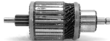
IM 3154 24 V 1.4 Kw Replacing: 1004011232 Servicing: 0001122201 Slots:28 Teeth:11 O.D.55,0 L. 149,5
