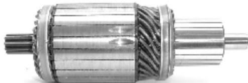
IM 3134 24 V 4.5 Kw Replacing: 132012100X0, 235787 Servicing: 03555020040, 03555020050, 03555020110 Slots:23 Teeth:9 O.D.54,00 L.164,5
