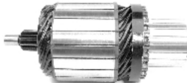
IM 3100 24 V - 24 V version of 10465167 Slots: 21 Teeth: 12 O.D. 52,9 L. 120,5
