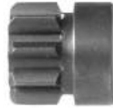
134177# Dp Gear ID 14.00, OD 34.30, Height 42.60, No./ teeth 9
