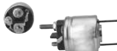
330689 Solenoid Replacing: 594724 Servicing: D6G5 12 V, B+ M8, Kl. 50 M6, OD 54.29, Total length 89.46, Height/ B+ 20.80, Width/ kl. 50 7.37, Coil bolt M8, Coil bolt 2 9.32, No./ terminals 3
